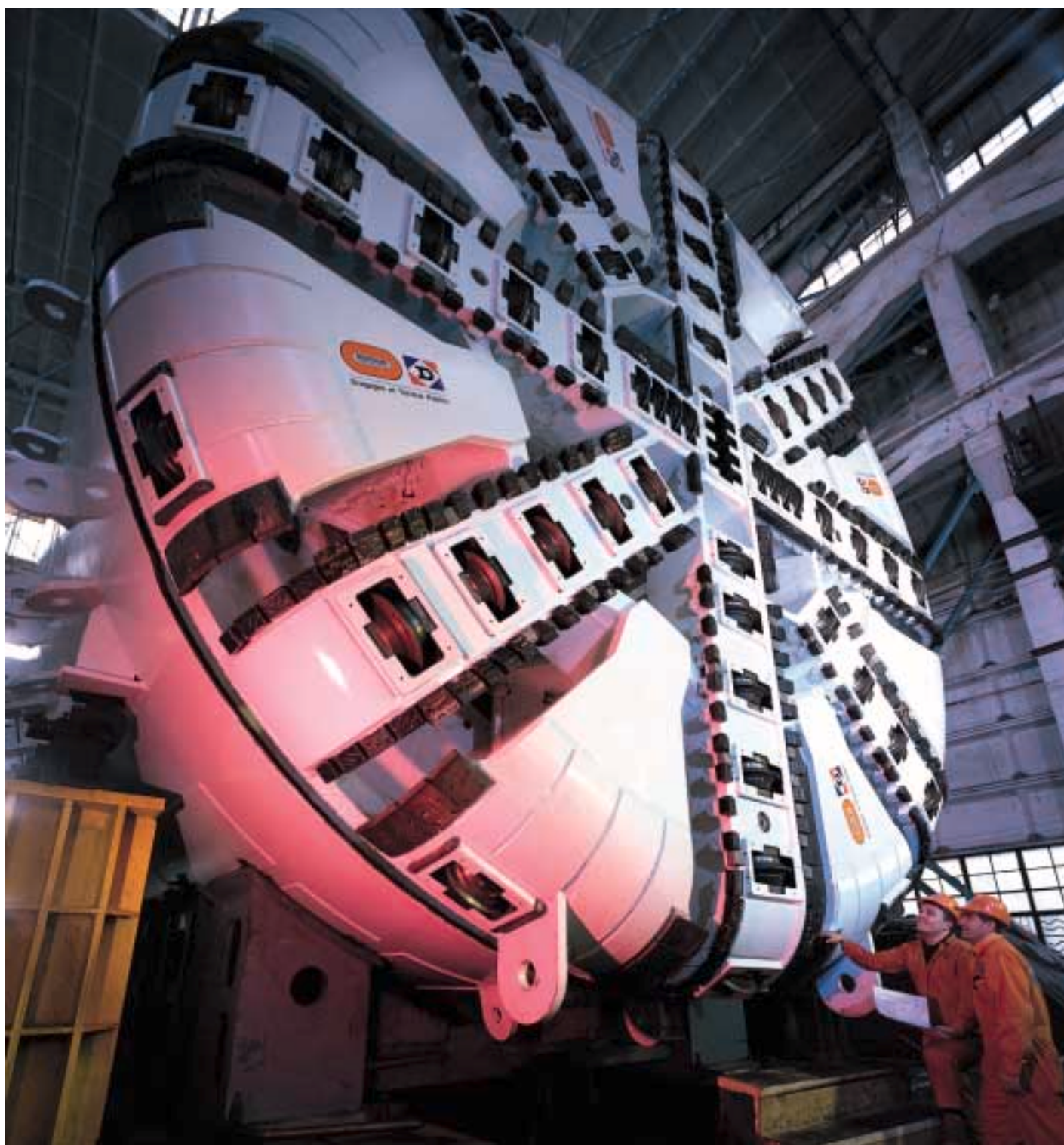
A first in Hong Kong : a 8.7m-diameter TBM was used for excavation 香港開埠以來首次採用一部直徑達 8.7 米的鑽挖機進行隧道開鑿工程
